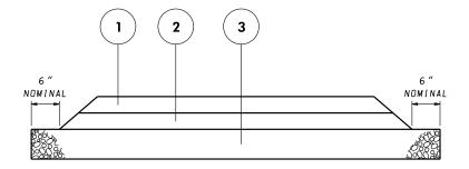
① 2" SUPERPAVE ASPHALT MIX 9.5mm FOR SURFACE, PG64S-22, LEVEL 2 ② 3" SUPERPAVE ASPHALT MIX 19.0mm FOR BASE, PG64S-22, LEVEL 2 ③ 6" GRADED AGGREGATE BASE
