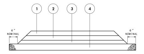
① 2" SUPERPAVE ASPHALT MIX 9.5mm FOR SURFACE, PG64S-22, LEVEL 2
